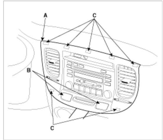
3. 分离后窗除霜器开关和危险警告灯开关（B）连接器。
